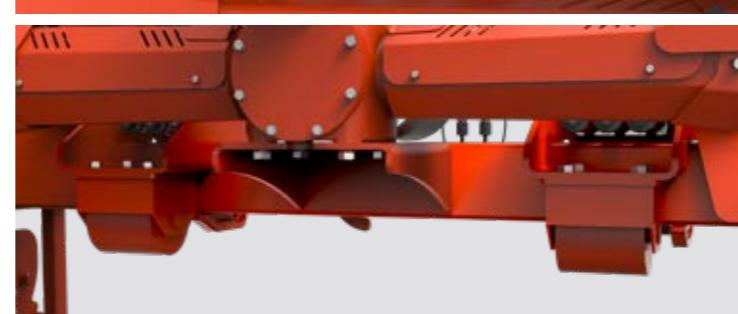
Verrouillage de transport hydraulique
